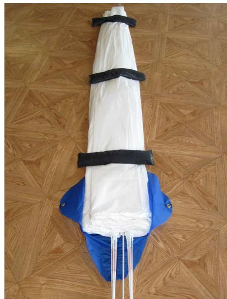
Glisser le pod sous la base de la voilure en le tournant de sorte que le rabat muni de l'élastique se trouve sous la voilure.
