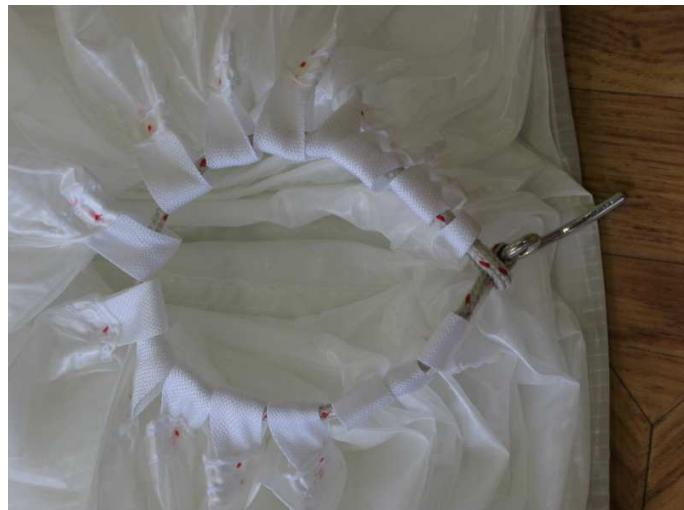
Mettre le parachute en tension à l'aide des boucles de pliage situées sur les coutures de panneaux au point d'équilibre entre les suspentes et la corde centrale.
