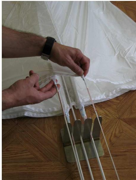
Contrôler que les deux suspentes inférieures et que les deux suspentes supérieures courent librement de la voilure aux élévateurs.
