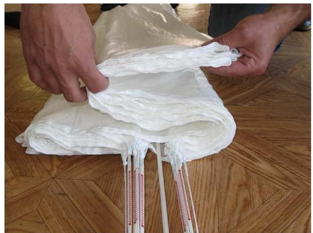
Lover la partie gauche du sapin en « S » sous la partie centrale puis lover la partie droite du sapin en « S » sur la partie centrale. Maintenir le lovage de la voilure avec des sacs de sable.
