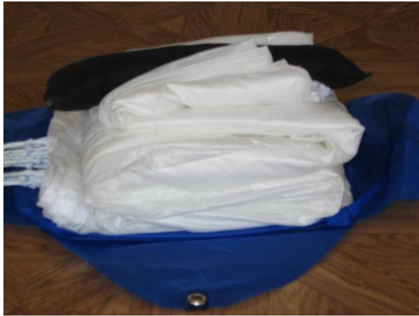
Lover la voilure à l'intérieur du pod en ménageant un petit espace en avant de la voilure pour le lovage ultérieur des suspentes.
