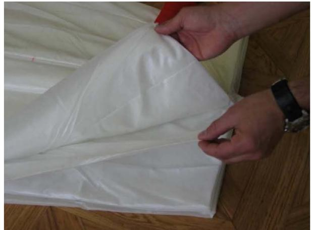
Contrôler à gauche et à droite, en haut et en bas que le nombre de panneaux sortis est identique et correct. En profiter pour parfaire l'alignement des bords d'attaque.
