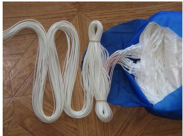
Lover les suspentes dans l'espace ménagé à l'avant de la voilure en gardant environ 0.5 à 1 m de suspentes pour le lovage extérieur.
