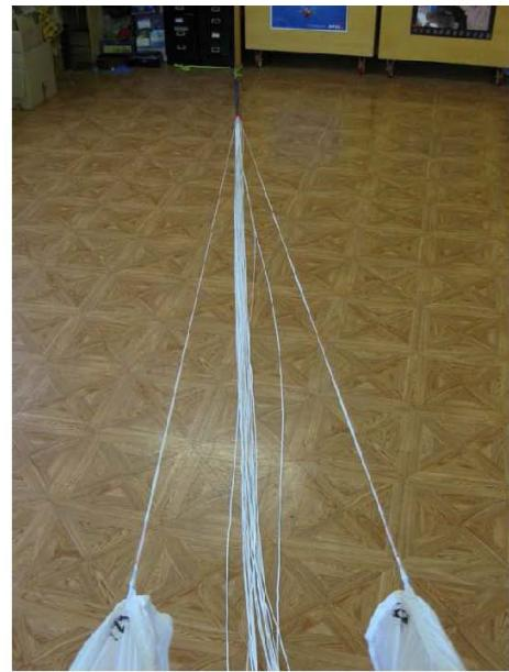
Contrôler que le parachute est parfaitement démêlé et que la première et la dernière suspente du nœud en tête d'alouette courrent librement de l'élévateur à la voilure.
