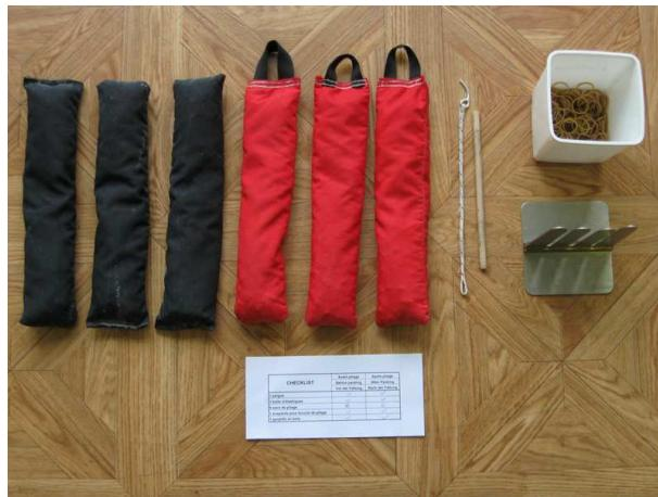
Vérifier que le matériel listé au début du pliage est complet et que par conséquent aucun accessoire de pliage n'est resté dans le parachute plié.
