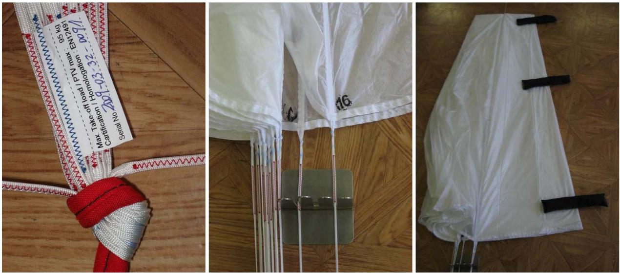
Dégager les deux suspentes extérieures sur l'élévateur, les mettre sur le peigne et arranger les panneaux en sapin en commençant par le panneau inférieur à droite (panneau 16). Arranger successivement tous les panneaux blancs à droite de bas en haut. Procéder de même avec les panneaux de gauche en commençant par le panneau 1.
